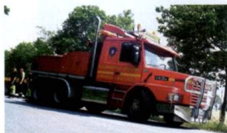
Zabudowa Scanii wyposażona jest m.in. w hydrauliczne ramię holownicze zakończone widelcem o nośności 20 ton, dwie wciągarki i podpory stabilizujące pojazd.
