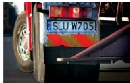
Ta część okulara zastępuje klasyczne łapy podporowe podczas pracy wyciągarki. Nadkola wykonane są z ryflowanej blachy
